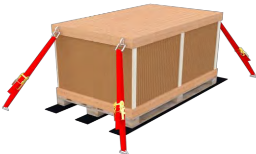
Diagonal para evitar inclinación
